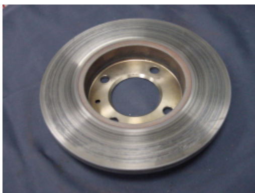
Disco defectuoso por mal montaje de la pinza.
