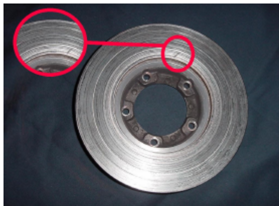
Disco defectuoso por holguras en los rodamientos.
